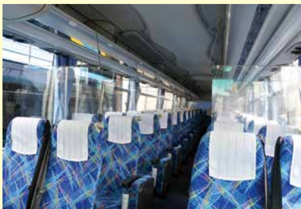
飛散防止板が設置された車内
