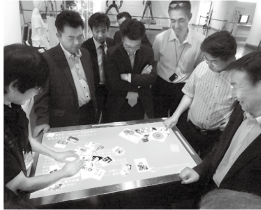
同時多数の接触を検知できるマルチタッチディスプレイ
