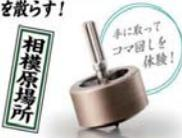
中小製造業が自社の誇りを賭けて作成したコマを持ち寄り、一対一で戦う大会です。コマ大戦にて使用されるケンカゴマは直径20mm以下、一円玉より小さいコマです。その小さなコマを製造業が本気で設計し、プロの機械を使用して自社の持てる技術を全て注ぎ込み作成します。
