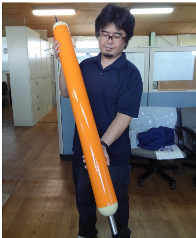
浅海域向け小型軽量・低価格の潜水ロボット＝菅原モデル
