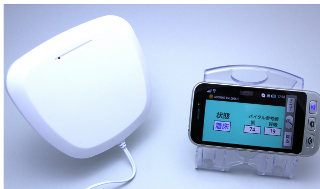
マイクロ波を使用して脈、呼吸を検知するバイタル感知見守りシステム＝ミオ・コーポレーション
