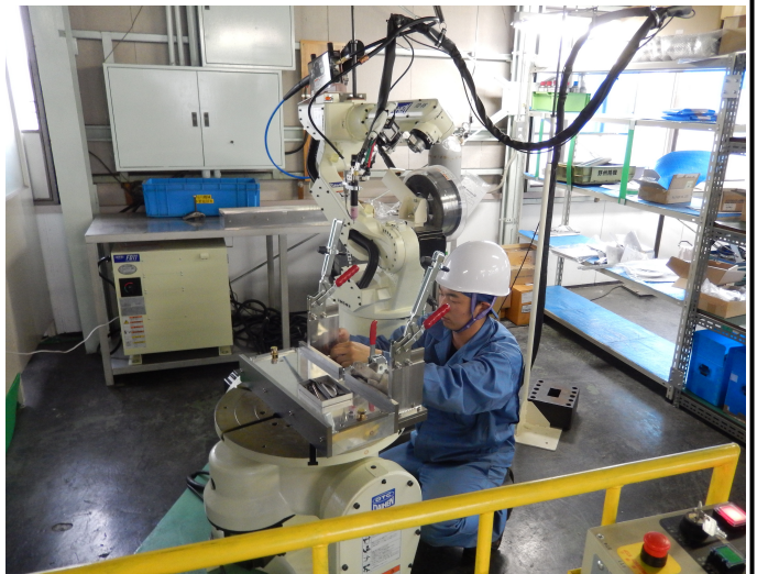
導入したロボット溶接機
